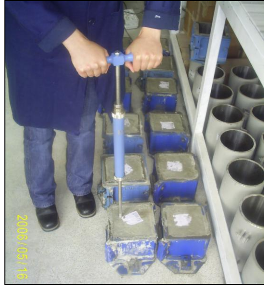
Şekil 2. Penetrasyon deney aletinin deneyde uygulaması
