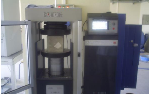
Şekil 2. Beton basınç dayanımı deneyi
