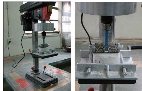
Şekil 2. Aşınma dayanımı deney cihazı ve aşındırma aparatı
