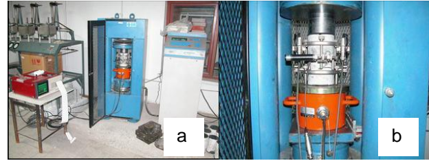
Şekil 1. Deformasyon kontrollü beton basınç dayanımı deneyi
