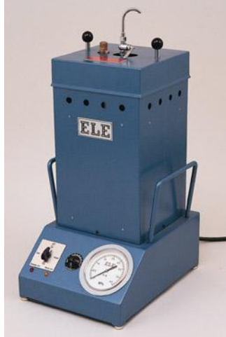
Şekil 4. Deneyde kullanılan yüksek basınçlı buhar kürü kazanı (otoklav)
