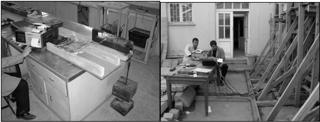
Resim 4.4 Streingeç lamaları belirli kuvvetler uygulayarak kalibrasyonu ve kalıplara yerleştirildikten sonra kontrol işlemleri
