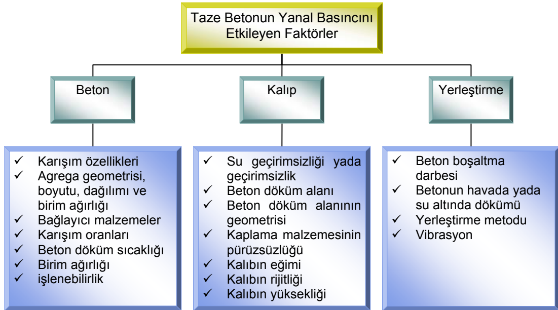
Şekil 3.13 CIRIA 108' göre taze beton yanal basıncını etkileyen faktörler
