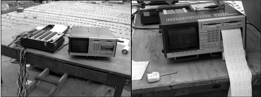
Resim 4.5 Beton dökümü ve priz süresince yanal basınç değerlerinin data logera kayıtlı edilmesi
