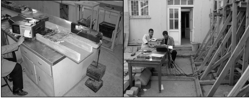
Şekil 6-6 Streingeç lamaları belirli kuvvetler uygulayarak kalibrasyonu ve kalıplara yerleştirildikten sonra kontrol işlemleri
