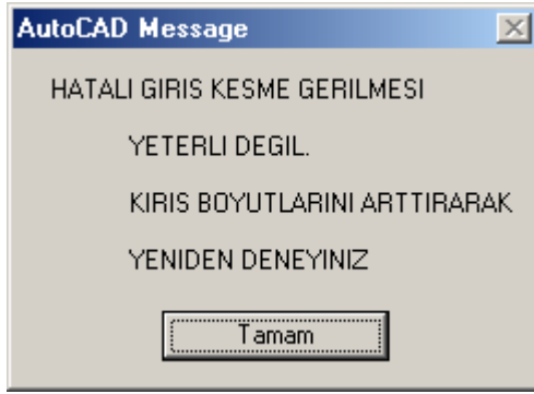
Şekil 5-12. Kesme gerilmesinin kontrolü
