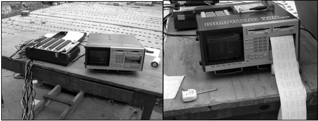
Şekil 6-7 Beton dökümü ve priz süresince yanal basınç değerlerinin data logera kayıt edilmesi
