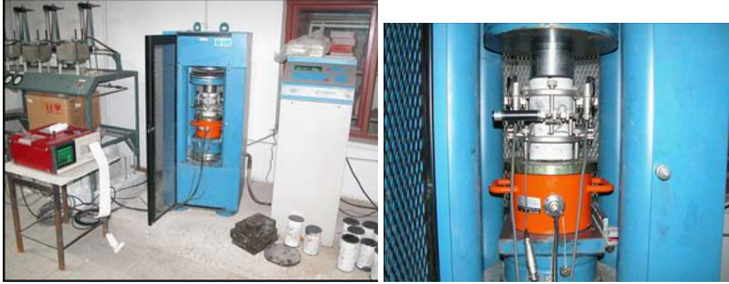
Resim 3.4. Deformasyon kontrollü beton basınç dayanımı deneyi
