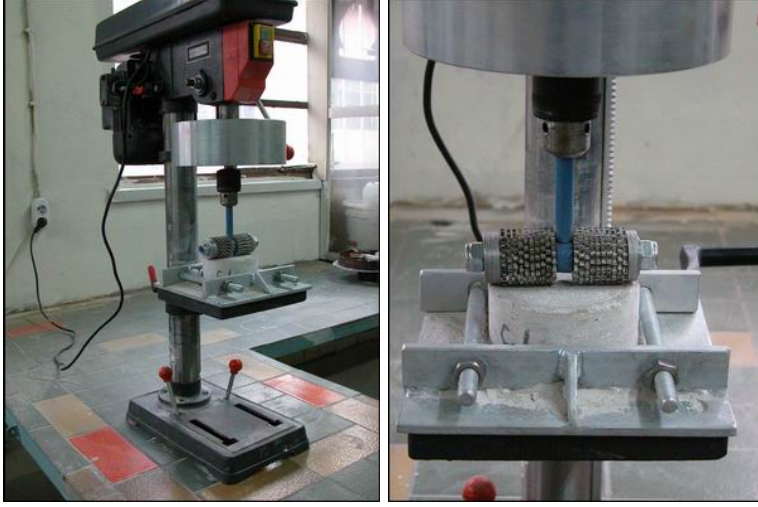
Resim 3.6. Aşınma dayanımı deney cihazı ve aşındırma aparatı
