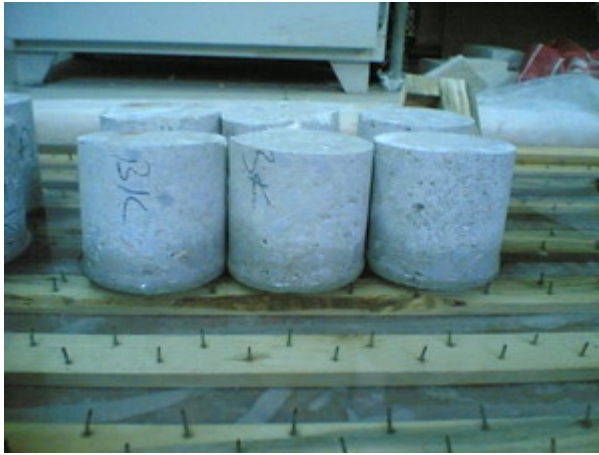
Resim 3.5. Kapiler su emme deneyi
