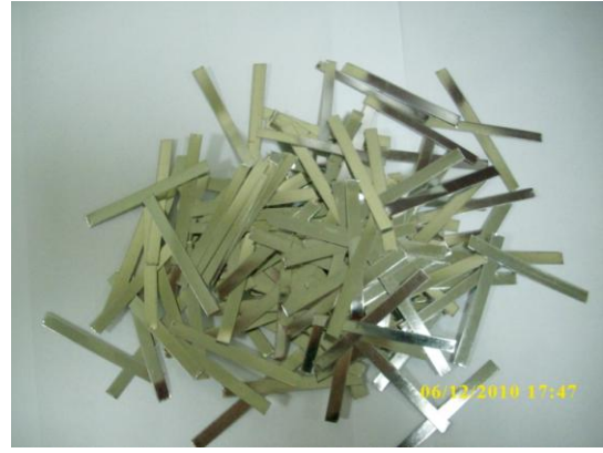
Şekil 2. TP-2 Kodlu atık tenekenin kesildikten sonraki görünümü
