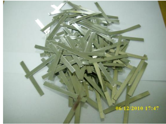
Şekil 3. TP-3 Kodlu atık tenekenin kesildikten sonraki görünümü
