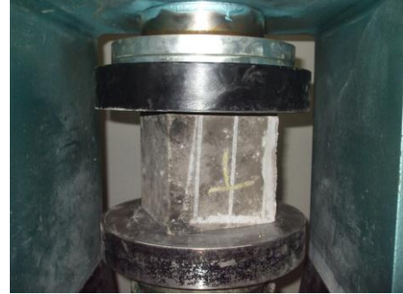
Şekil 8. Küp numunelerin basınç dayanım testi öncesi görünümü.
