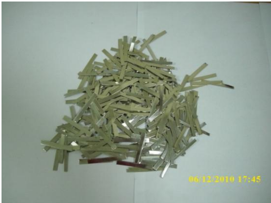
Şekil 1. TP-1 Kodlu atık tenekenin kesildikten sonraki görünümü
