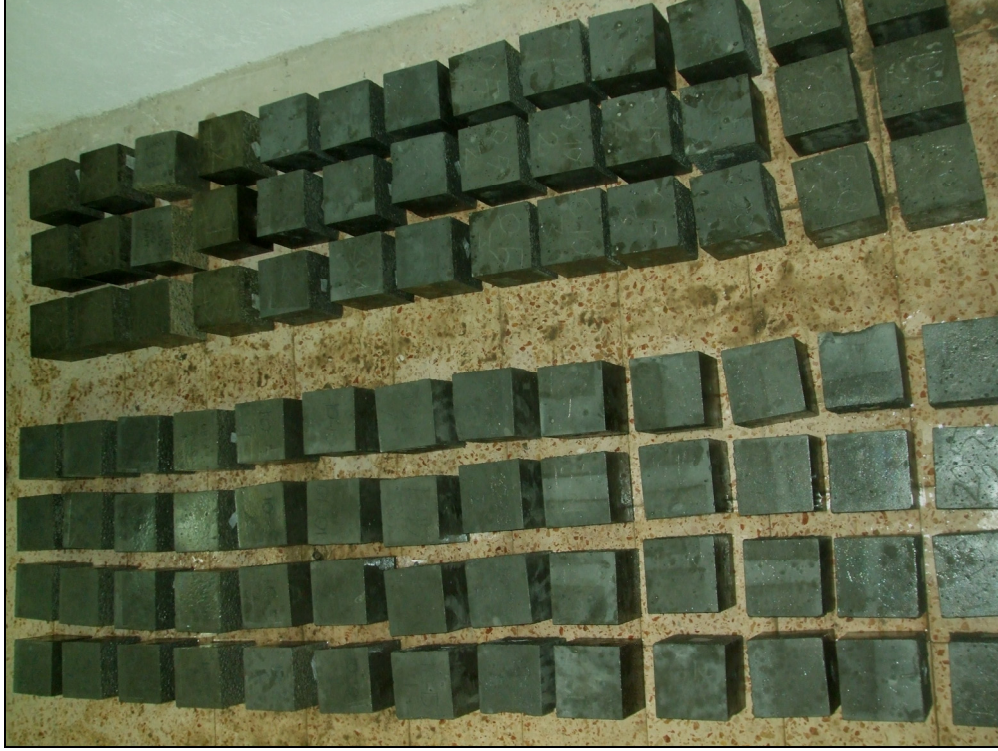
Şekil 3.3. Beton deneylerini yapmak üzere kür tankından çıkarılan bazı beton örnekleri
