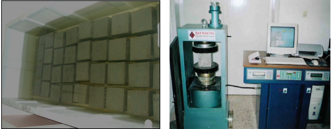
Şekil 3.2. Kür havuzunda bekletilen beton örnekleri ve tek eksenli basınç aleti
